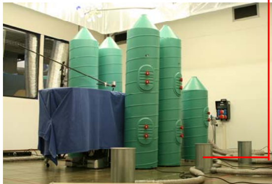
Abbildung 3 Einbau nach SWKI Richtlinie 99-3: Bestimmung der Schutzwirkung gegen externe Lasten
